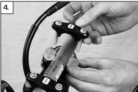
Obere Lenkerschalen (7) mit vormontiertem Zwischengummi (8), Schrauben (10) und Elastomeren (9) aufsetzen.
