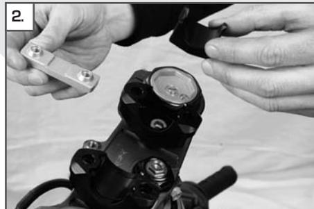
Klemmbalken (5) in Grundträger (1) einführen (Kegel nach oben) und die untere Lenkerschale (6) in den Klemmbalken (5) einrasten.
