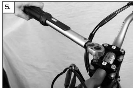
Gleichmäßig die Schrauben (10) einschrauben und mit 16 Nm festschrauben, dabei auf einen gleichgroßen Klemmspalt zwischen den Schalen (6) + (7) achten. Siehe Bild richtig / falsch
