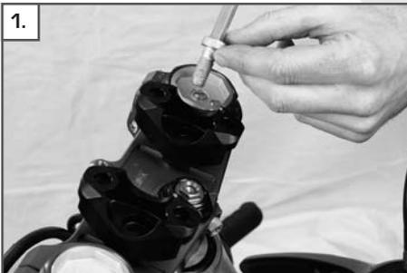
Grundträger (1) mit vormontierten Kegelgummi (2) auf die Gabelbrücke aufschrauben (M10x25) (4) und mit 40Nm festschrauben. Wenn nötig Erhöhungen (3) beilegen, dabei jedoch die Schrauben M10x35 verwenden. **HINWEIS:** Auf gleiche Versatzrichtung achten.
